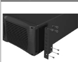
(Ilustr. 3-a) Montaż kątowników montażowych do UPS
